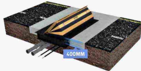
Il **road blocker** HRB shallow mount resiste agli impatti a una velocità di 81,4 km/h da parte di veicoli che pesano a pieno carico 7.350 Kg. La sua componente mobile si solleva fino a raggiungere un angolo di 45° ed è stato progettato in modo da non necessitare di uno scavo profondo per la posa misurando solo 400 mm. È l'ideale nei contesti urbani in quanto concepito per durare nel tempo e resistere a intensi cicli di utilizzo e stress.
